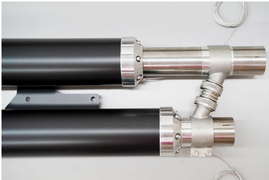
**Der Endtopf für den vorderen Zylinder ist der mit dem kürzeren Anschluss (siehe Foto, Ansicht von vorne).**
