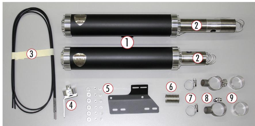
**ACHTUNG:** Bei der Montage alle Schrauben mit Schraubensicherungspaste (blau, mittelfest) sichern.
