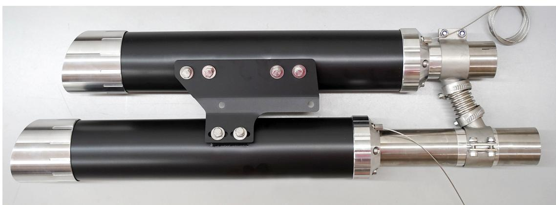
Auspufftöpfe umdrehen (Ansicht von hinten) und den Auspuffhalter (5) mit den Sechskantschrauben, Sprengringen und Karosseriescheiben an den Endtöpfen anbringen.
