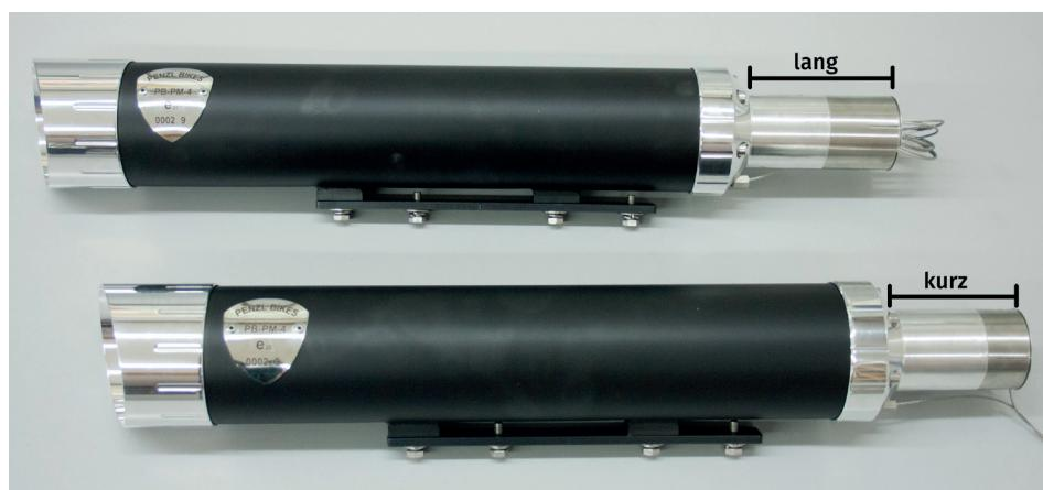
**Der Endtopf für den vorderen Zylinder ist der mit dem kürzeren Anschluss (siehe Foto).**
