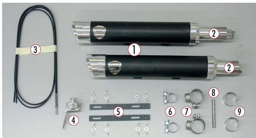
**ACHTUNG:** Bei der Montage alle Schrauben mit Schraubensicherungspaste (blau, mittelfest) sichern.
