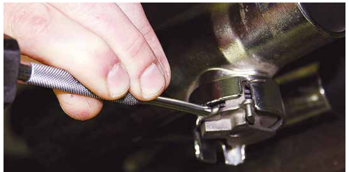
4. Montage der SMS-Klemme (nur leicht schlagen, da ansonsten die Klemme verformt werden könnte und somit Ihre Fixierung verliert)
