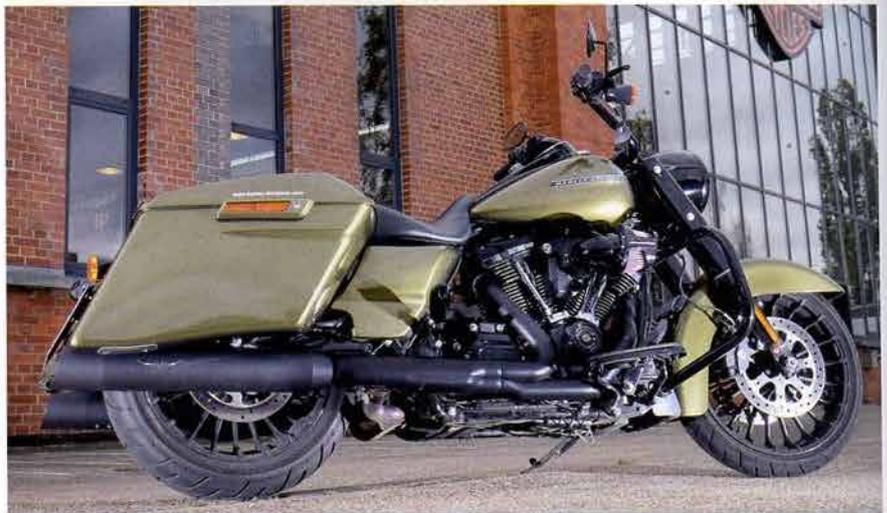
Optisches Highlight der Penzl V2 ist die schräge Endkappe C-5 in mattschwarz. Die Montage ist sehr aufwendig, da u.a Bowdenzüge konfektioniert werden müssen
