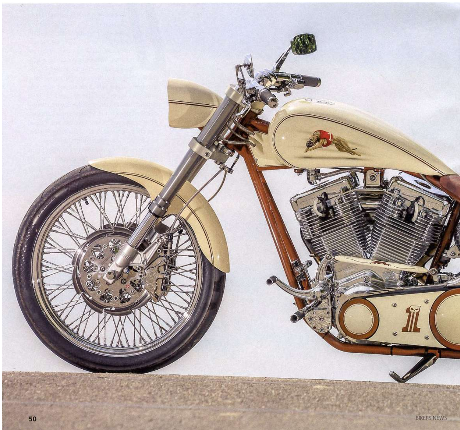
Der Tacho ist in die Gabelbrücke eingelassen. Die Wave-Bremsscheiben sehen nicht nur extravagant aus. Sie liefern auch eine effiziente Kühlung
