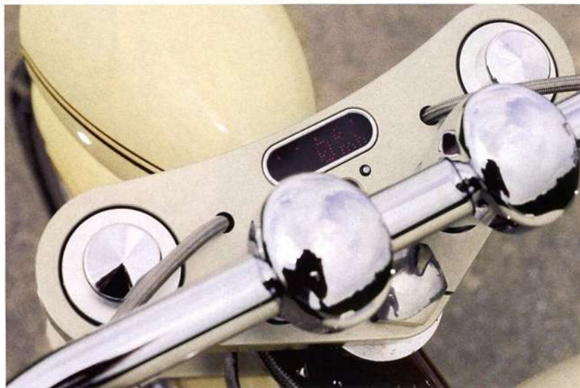
Der Tacho ist in die Gabelbrücke eingelassen. Die Wave-Bremsscheiben sehen nicht nur extravagant aus. Sie liefern auch eine effiziente Kühlung
