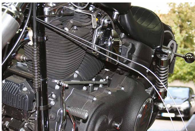
Die Seilzughüllen wieder auf **Anschlag** in die Seilstellschrauben einschieben um bei der nachfolgenden Synchronisierung der beiden Verstellklappen der Auspuffköpfe keine Probleme zu bekommen.
