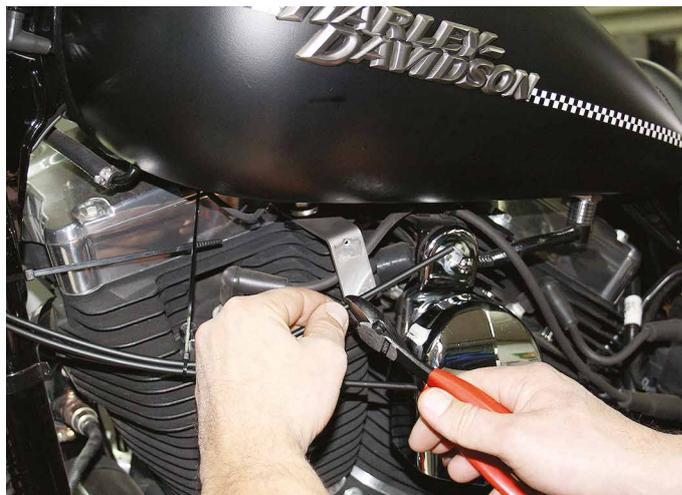
Die Seilzüge wieder komplett durch die Seilzughüllen einschieben, dass die Enden sichtbar hervorstehen.
