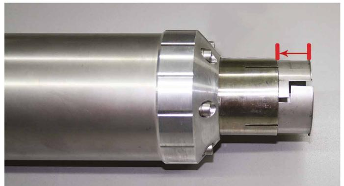
**ACHTUNG:** Bei einer neu bestellten PM-Auspuffanlage von PENZL-BIKES® befindet sich die Edelstahldichthülse im Anschlussrohr. Sie müssen nur noch korrekt ausgerichtet werden.
