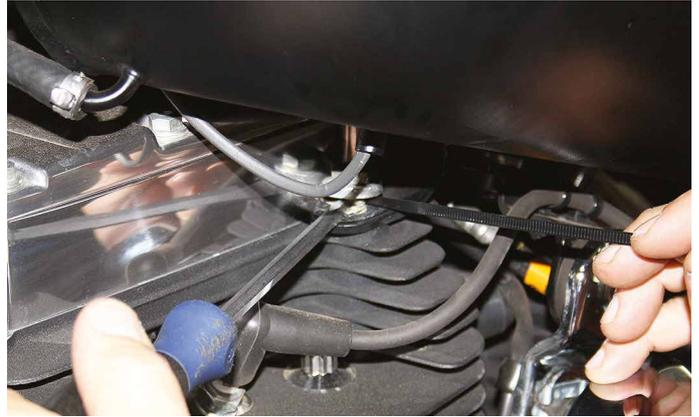
Sobald alle Kabelbinder fest fixiert sind, nimmt man als Orientierung für den Schnittpunkt der Seilzughüllen die Mitte des Stellhebelhalters. Als Markierung kann man einen kleinen Kabelbinder an der Stelle anbringen, bei der man die Seilzughüllen abzwicken muss.
