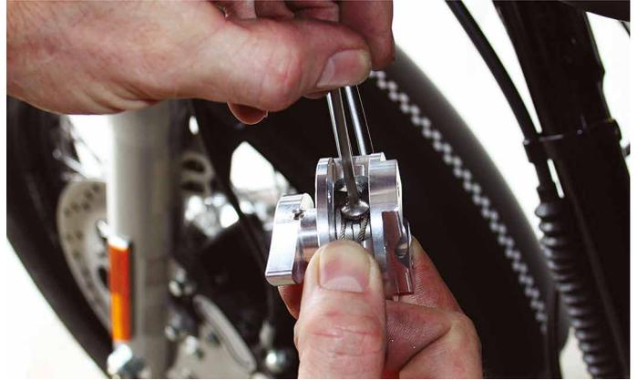
Mit noch nicht gekürzten Seilzügen und verschiedenen Hebelstellungen die Synchronität beider Auspuffröfpe überprüfen.
