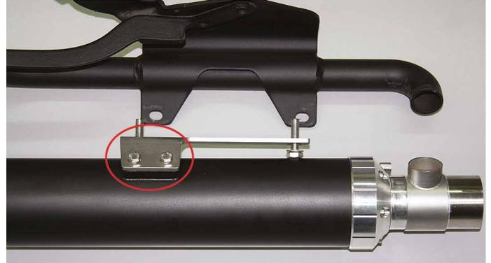
Nach der Montage der Auspuffanlage müssen die Laschen der Interferenzrohr-Schellen unterhalb der Krümmerabdeckungen sichtbar sein.
