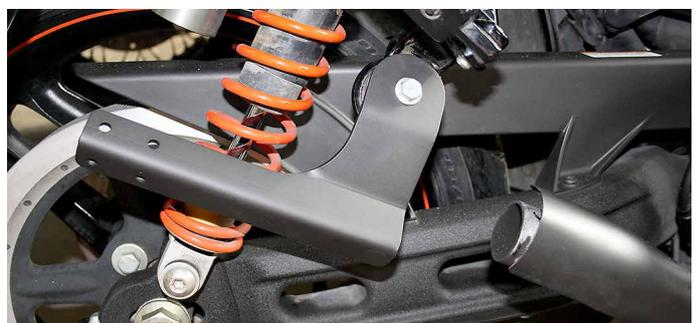
Als erstes den Auspufftopf des vorderen Zylinders mit Dichthülse und Schelle aufstecken. Dazu den Auspufftopf mit einem Tuch abdecken um Beschädigungen zu vermeiden. Mit den Schrauben M6x14 plus Sicherungsringen und Loc-tite® (Farbe blau „mittelfest“) an dem Auspuff-Halter befestigen und lose vormontieren. Die Schelle noch nicht festziehen. Den Auspuff des hinteren Zylinders in der gleichen Vorgehensweise anbringen. Die Schelle noch nicht festziehen.
