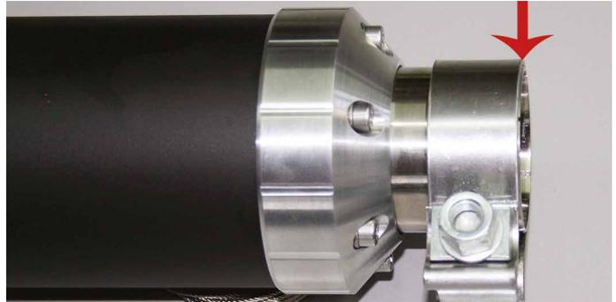
Originale Auspuffköpfe und Abdeckungen der Krümmer abbauen. Den hinteren originalen XR® Auspuffhalter entfernen, da dieser nicht mehr benötigt wird. Mitgelieferte Alu-Distanz gegen Original-Vibrationsdämpfer austauschen.
