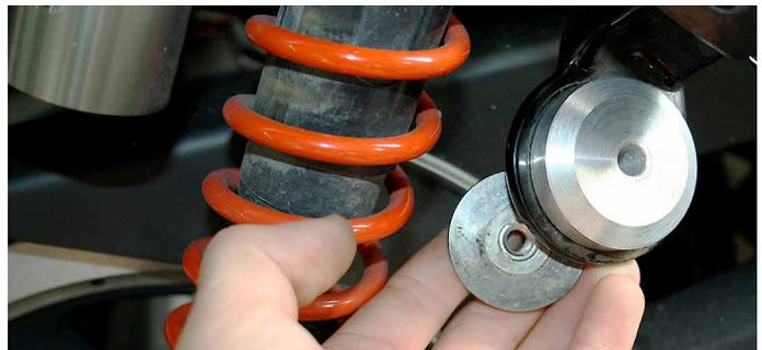
Mit der originalen Scheibenmutter die mitgelieferte Penzl-Bikes® Auspuffhalterung und die Alu-Distanz lose befestigen, so dass diese mit den Auspuffköpfen noch ausgerichtet werden kann.
