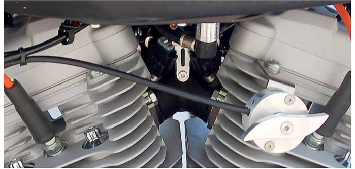
Sobald die Kabelbinder der Seilzüge fest fixiert sind, nimmt man als Orientierung für den Schnittpunkt der Seilzughüllen die Mitte des Stellhebelhalters. Als Markierung kann man einen kleinen Kabelbinder an der Stelle anbringen, bei der man die Seilzughüllen abzwicken muss.
