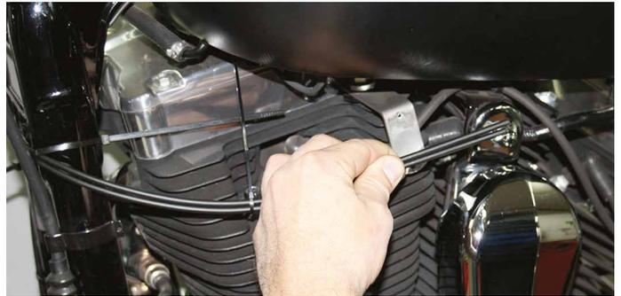
Hat man die Länge wie beschrieben festgelegt, muss man **vor** dem Ablängen der Seilzughüllen diese bei beiden Auspufftröpfen an den Seilstellschrauben aushängen. Dann die Seilzüge soweit zurückziehen das sie beim Ablängen der Seilzughüllen nicht mit gekürzt werden.
