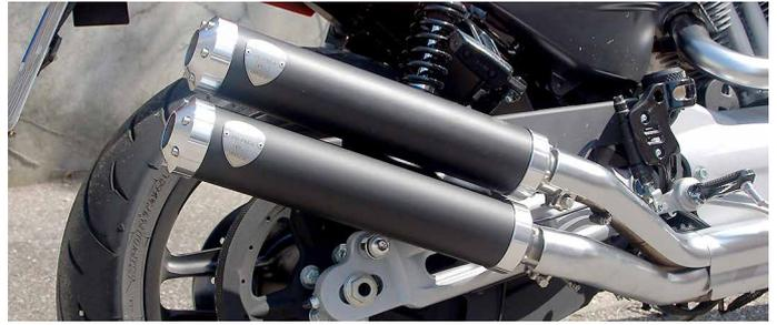
1. Die 4 Sechskantschrauben M6 der vier Halteklötze der beiden Auspufföpfe anziehen.
