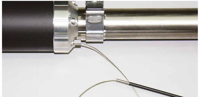
Jetzt können die Seilzughüllen mit einem Seitenschneider gekürzt werden. Dabei beachten, dass die abgezwickten Enden der Seilzughüllen nicht nach innen stehen und die Seile klemmen. Die Seile müssen sich nach dem Einschleiben in die Seilzughüllen ungehindert bewegen können. Die Seile wieder komplett durch die Seilzughüllen einschieben, dass die Enden sichtbar hervorstehen.
