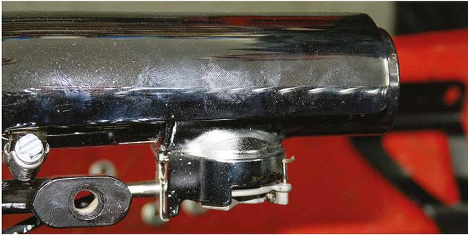
2. SMS-Klemme für die originale Soundmanagementklappe H.D.<sup>®</sup>
