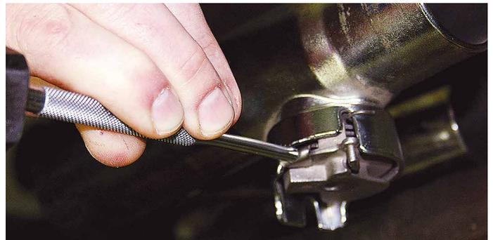
5. Montierte SMS-Klemme in der orig. Soundmanagementklappe von H.D.<sup>®</sup>
