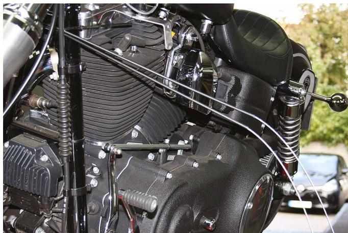
Die Seilzughüllen wieder auf **Anschlag** in die Seilstellschrauben einschieben um bei der nachfolgenden Synchronisierung der beiden Verstellklappen der Auspufftröfpe keine Probleme zu bekommen.
