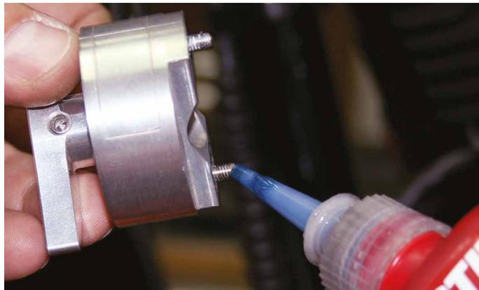
Der Knebel des Stellhebels ist mit einer Madenschraube (2) seitlich zur Achse befestigt. Stirnseitig im Knebel befindet sich die Bremsstellschraube (1) des Stellhebels. Mit Hilfe dieser beiden Schrauben kann jederzeit und so oft man möchte die Bremseinstellung, welche die stufenlose Betätigung und Fixierung der Soundklappen gewährleistet, verändert werden.
