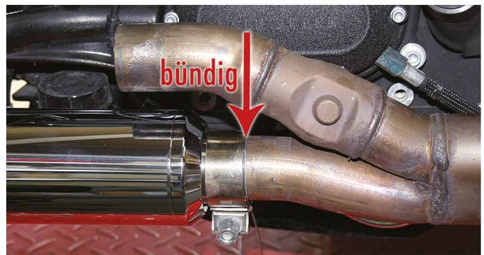
Mit den zwei Schrauben M6 plus Sicherungsringen, Beilagscheiben und Loctite® (Farbe blau „mittelfest“) an dem Halter befestigen. Auf eine sorgfältige Befestigung ist zu achten, ansonsten könnten sich die Auspufftöpfe lockern und somit die Gefahr eines Unfalls entstehen. Die Schelle noch nicht festziehen. Beide Töpfe sind gleich, eine Verwechslung ist ausgeschlossen.
