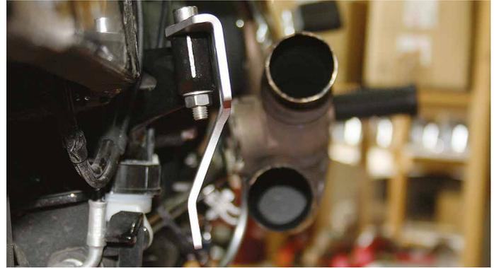
Als erstes den Auspufftopf des vorderen Zylinders mit Dichthölse und Schelle aufstecken. Dazu den Auspufftopf mit einem Tuch abdecken.
