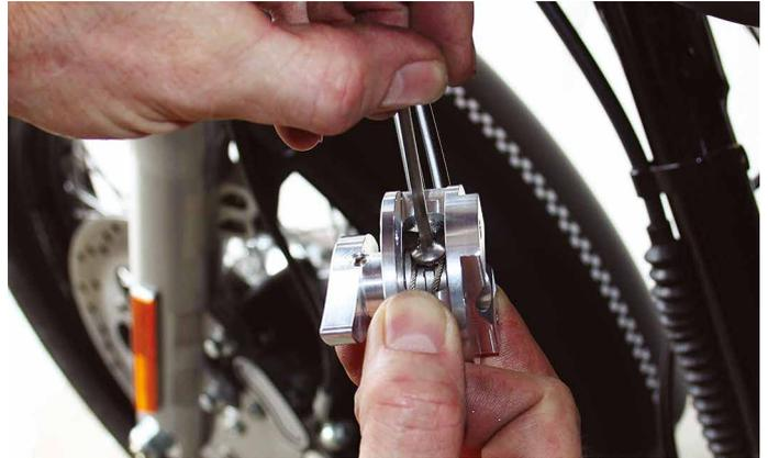
Mit noch nicht gekürzten Seilzügen und verschiedenen Hebelstellungen die Synchronität beider Auspufftöpfe überprüfen.
