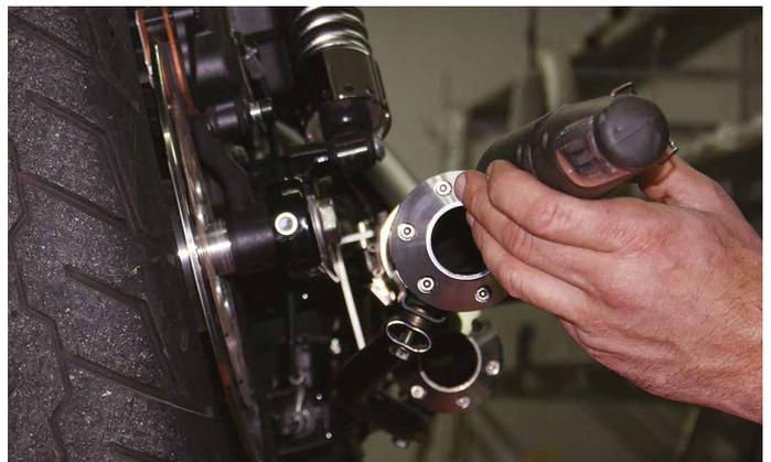
Sind beide Klappen synchron eingestellt, können mit unserer speziell auf die Größe angefertigten Monierzange (bei uns erhältlich, Bestellnummer: PM60608100) oder einem kleinen Seitenschneider beide Seile so „kurz“ wie möglich gekürzt werden.
