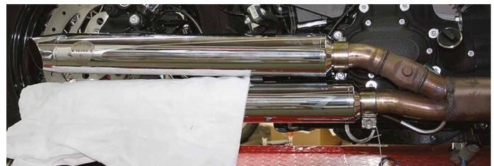
Zum Ausrichten der Auspuffanlage auf Länge die Krümmerabdeckungen provisorisch aufstecken. So an den Auspufftöpfen ausrichten, dass die Abstände der Krümmerabdeckungen zu den Anschlusskappen gleichmäßig sind.
