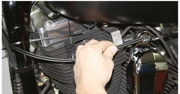
Hat man die Länge wie beschrieben festgelegt, muss man **vor** dem Ablängen der Seilzughüllen diese bei beiden Auspufftröpfen an den Seilstellschrauben aushängen. Dann die Seilzüge soweit zurückziehen das sie beim Ablängen der Seilzughüllen nicht mit gekürzt werden.
