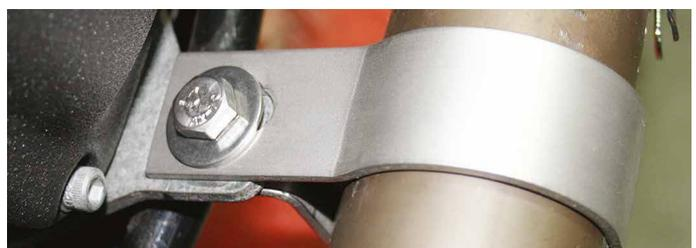
Die im Lieferumfang enthaltene Halterung mit der 50mm langen M8-Inbusschraube plus Karosseriescheibe anbringen. Von unten mit der M8-Sicherungsmutter plus Beilagscheibe vormontieren, so dass bei der Montage der Auspufftöpfe die Halterung noch bewegt werden kann.
