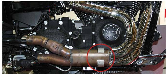
Die Muttern an den Stehbolzen des Auspuffkrümmer lösen, so dass ein spannungsfreier Anbau der Zusatzhalterung gewährleistet ist.
