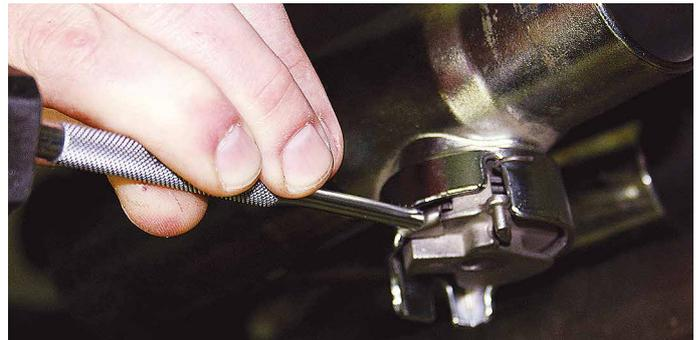
5. Montierte SMS-Klemme in der orig. Soundmanagementklappe von H.D.®
