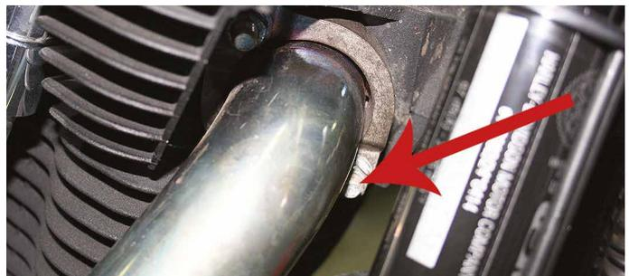
Die Halteplatte der Zusatzhalterung an der unteren rechten Seite des Motorblocks mit den mitgelieferten Schrauben und Sprengringen mit Loctite® (Farbe blau „mittelfest“) sichern und befestigen.
