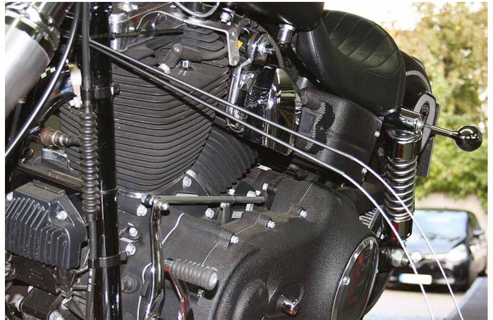
Die Seilzughüllen wieder auf **Anschlag** in die Seilstellschrauben einschieben um bei der nachfolgenden Synchronisierung der beiden Verstellklappen der Auspufftröfpe keine Probleme zu bekommen.
