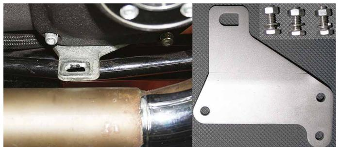
Den Auspuffkrümmer mit Hilfe der zweiteiligen Auspuffschele oberhalb und unterhalb der Halteplatte befestigen. Dazu benötigt wird die Sechskantschraube, die Karosseriescheiben und die selbstsichernde Mutter.
