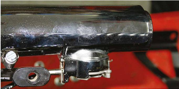
2. SMS-Klemme für die originale Soundmanagementklappe H.D.<sup>®</sup>
