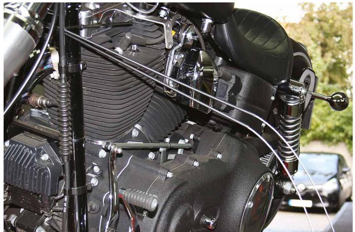
Die Seilzughüllen wieder auf **Anschlag** in die Seilstellschrauben einschieben um bei der nachfolgenden Synchronisierung der beiden Verstellklappen der Auspufftröpfe keine Probleme zu bekommen.
