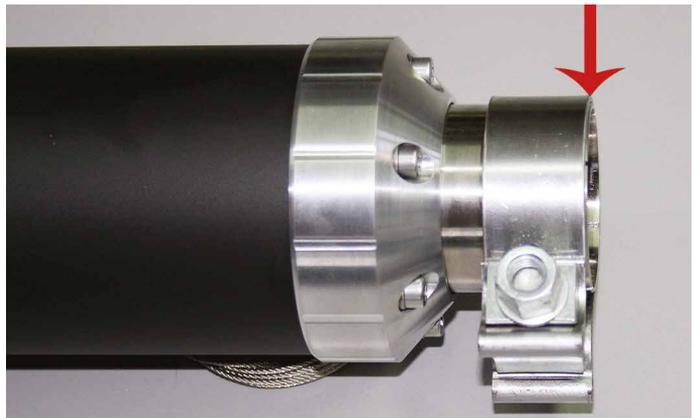
Orig. Auspuffköpfe und Krümmerabdeckungen abbauen. Die originale Halterung bleibt am Bike. Beide Krümmer lockern, so dass man sie leicht verdrehen kann.
