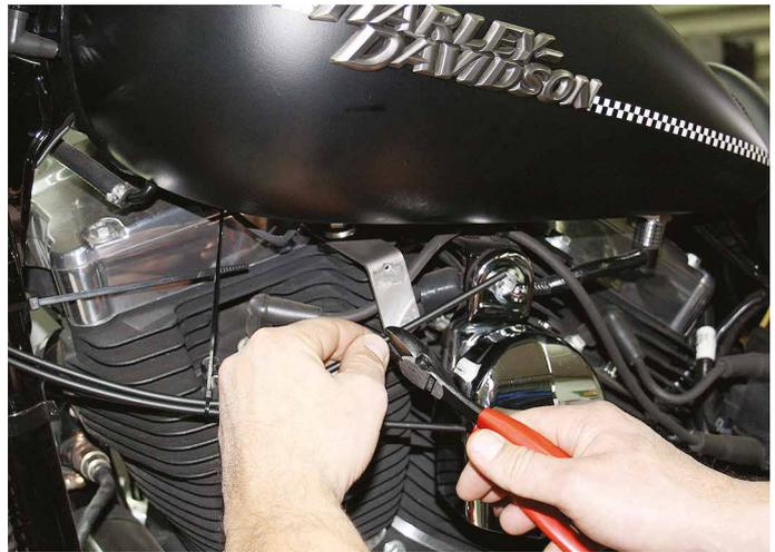
Die Seilzüge wieder komplett durch die Seilzughüllen einschieben, dass die Enden sichtbar hervorstehen.
