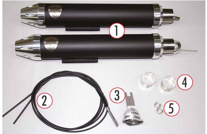
Die Dyna-Serie® bekam erst ab Bj. 08, ab Werk, eine Vertikalverbindung zwischen Endtöpfen und Rahmen. Eine Sicherung der Auspufftöpfe am Rahmen ist also erst seit 2008 original vorhanden. Für alle Modelle bis Bj. 07 haben wir ein Bauteil entwickelt, das die Auspufftöpfe auch hier am Rahmen befestigt sind.
