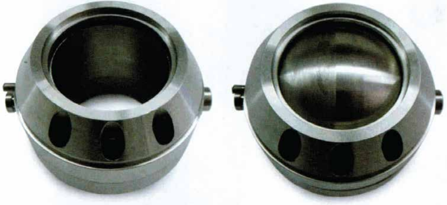
Das Kugelventil besteht aus drei Teilen. Bei geschlossenem Ventil strömen die Abgase durch die sechs außen sitzenden Löcher
