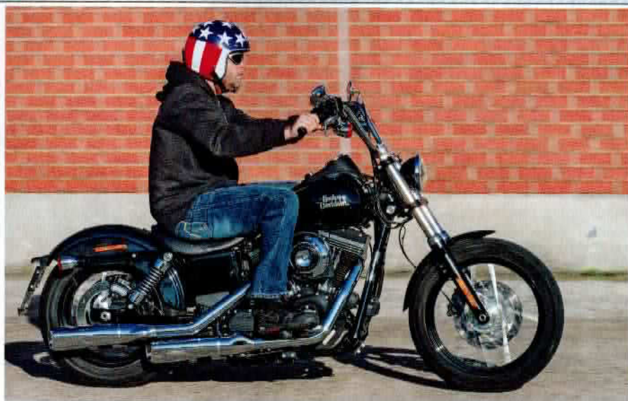
Die Optik der Akrapovic-Anlage folgt organischen Formen und ist eher cruiser-untypisch (oben). Beim Standgeräusch maßen wir 92,6 dB (rechts)
