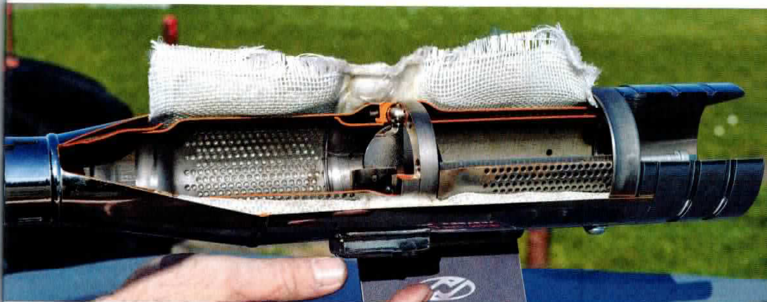
Das Innenleben eines Auspufftopfes: Gut zu erkennen sind Dämmstoff, Schalldämpfer und die Auspuffklappe
