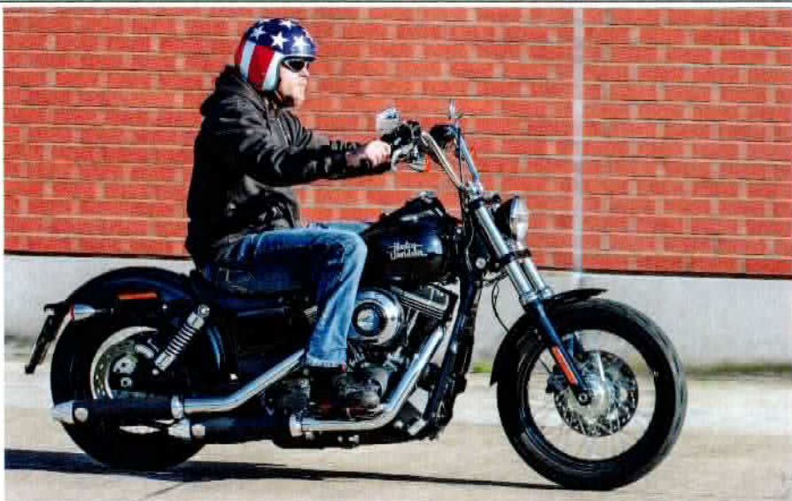
Die Penzl PM-Retro-Shorty-Anlage in mattschwarzem Finish mit Chrom-Endkappen (oben). Beim Standgeräusch maßen wir 89,1 dB (rechts)
