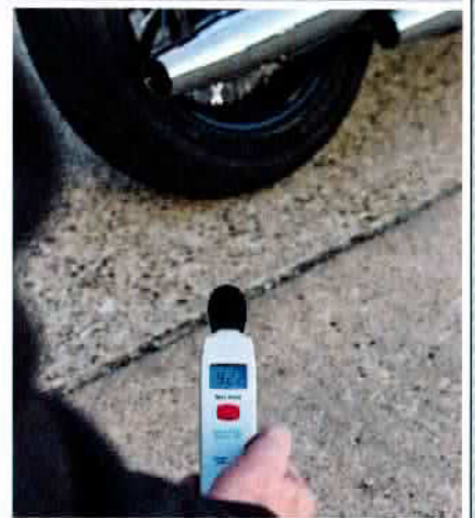
Die Gietl-Anlage kommt in Chrom-Optik und sieht dem Serienauspuff zum Verwechseln ähnlich (oben). Beim Standgeräusch maßen wir 92,2 dB (rechts)
