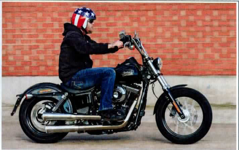
Die Zero Cool ist eine Komplettanlage mit Krümmern. Die Auspufftöpfe werden parallel geführt (oben). Beim Standgeräusch maßen wir 89,7 dB (rechts)
