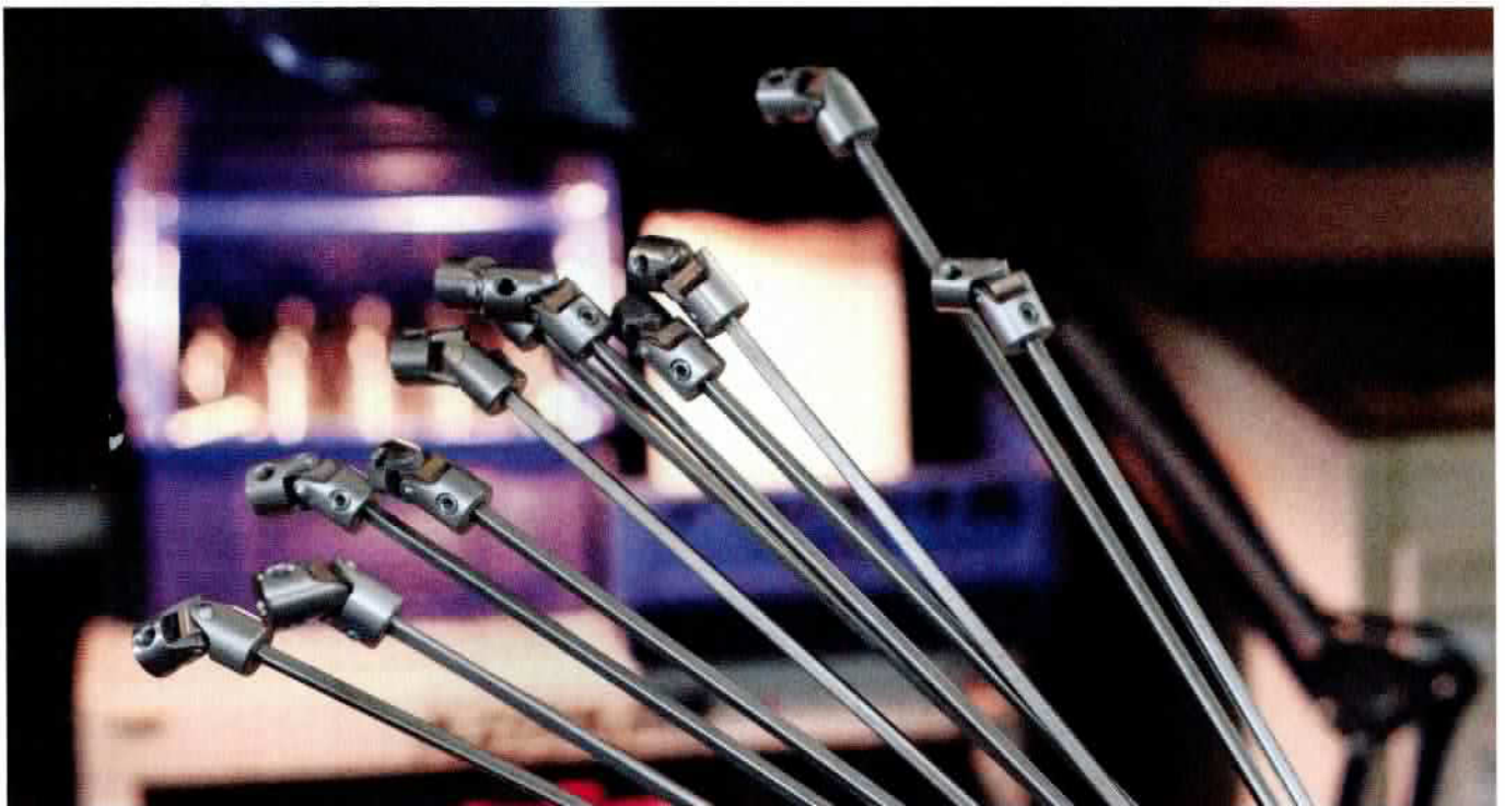
Die Steuerung der Auspuffklappen kann per Stellmotor und Seilzug erfolgen oder mittels kleiner Wellen mit Kardangeln
