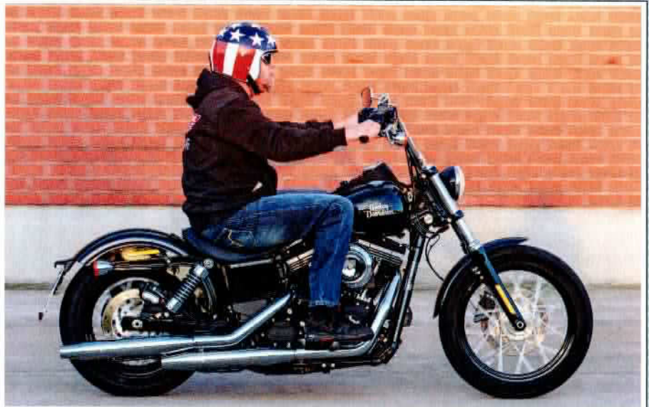
Die Gietl-Anlage kommt in Chrom-Optik und sieht dem Serienauspuff zum Verwechseln ähnlich (oben). Beim Standgeräusch maßen wir 92,2 dB (rechts)
