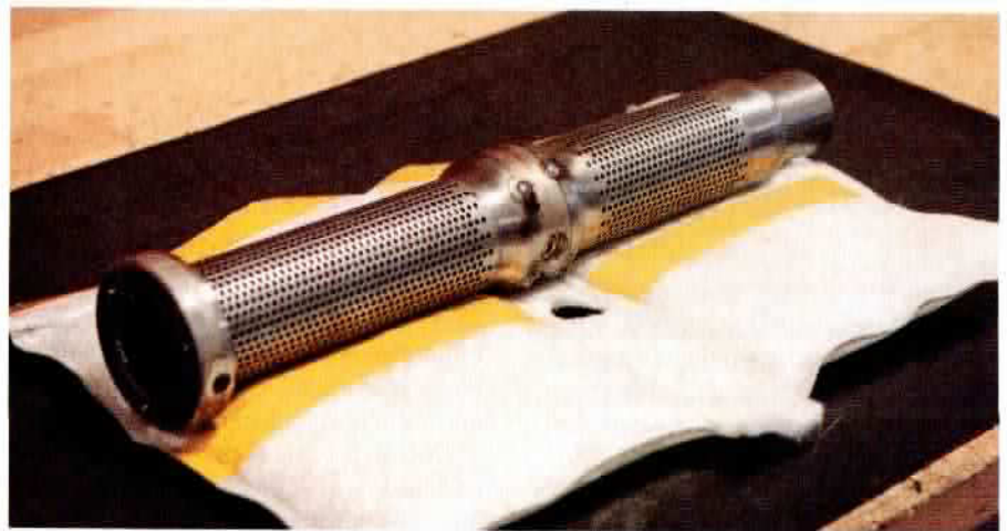
Der Schalldämpfer wird abschließend noch in Dämmstoff eingewickelt
