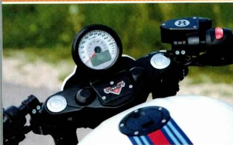
Ungewöhnlich für einen Cruiser sind die mehrfach verstellbaren Stummellenker (oben). Zündschlossabdeckung von H&B (rechts)
