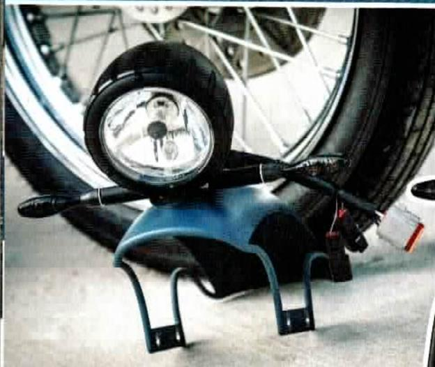
Ready for race: Mit nur wenigen Handgriffen sind die Fender und die daran verschraubten Beleuchtungseinheiten entfernt
