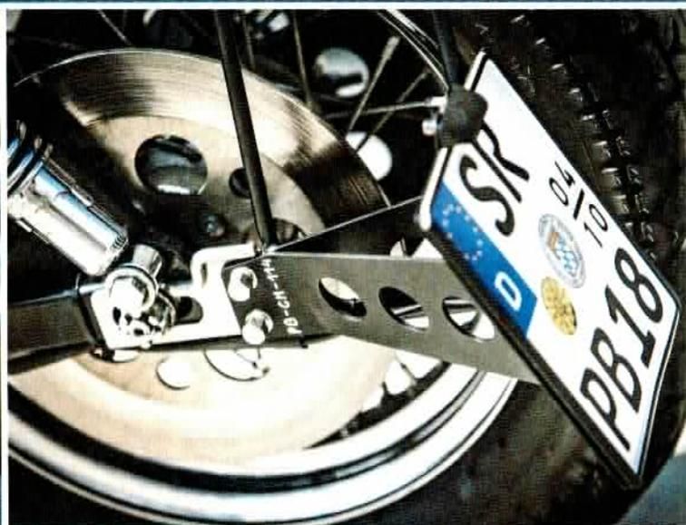
Am Platz der Lenkerriser sitzt nun ein Halter für den kleinen Tacho. Das STVZO-Gewerk hinten ist bloß mit zwei Schrauben befestigt
