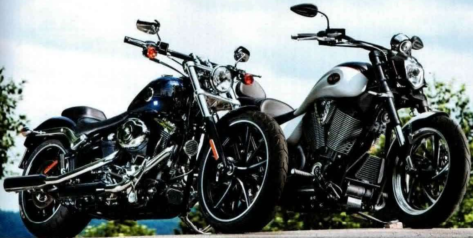
Das 130er-Vorderrad der Breakout in 21 Zoll und der längere Nachlauf fordern beim Handling Tribut. Die Hammer 8-Ball ist handlicher
