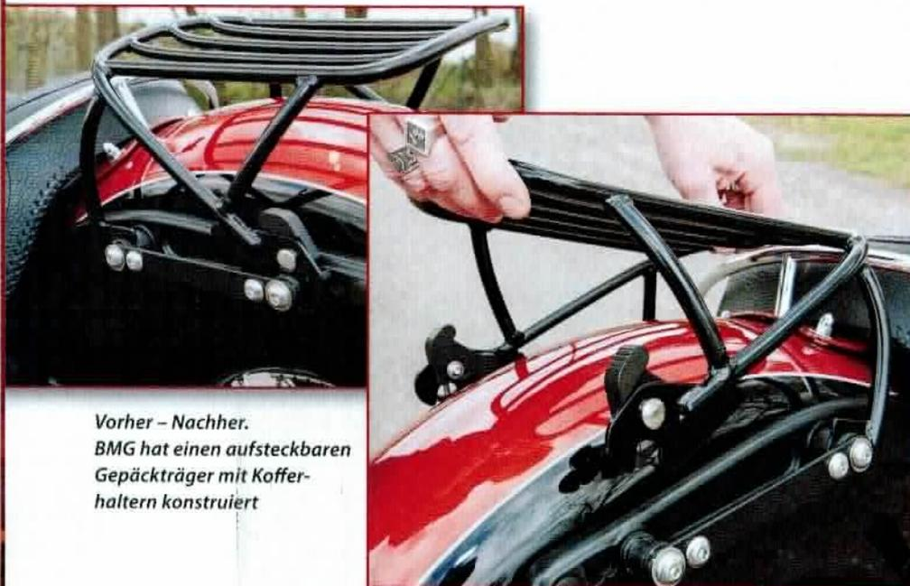
Vorher – Nachher. BMG hat einen aufsteckbaren Gepäckträger mit Kofferaltern konstruiert
